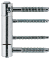
TOP320-FR S2 mit Ø9,8x60 mm Rahmengewindebolzen und Ø7x60 mm Flügelgewindebolzen
