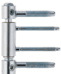
TOP320-RA Lift S4 mit Ø9,8x53 mm Rahmengewindebolzen und Ø7x60 mm Flügelgewindebolzen
