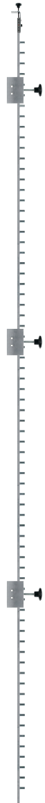
Aluminium-Trägerschiene: GSB3-TRA-FL mit 3 Bohrklötzen mit Dichtung im Überschlag: GSB3-TR217-BK-MD ohne Dichtung im Überschlag: GSB3-TR217-BK-OD
